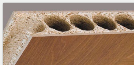
(B) Płyta wiórowo-otworowa
