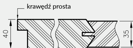
Przekrój poziomy drzwi Tizano, Tixa
