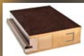
Skrzydło w technologii SOFT o grubości 46 mm z uszczelką, ramiaki drewniane wzmocnione ceownikiem stalowym gr. ścianki 2 mm, wypełnienie płyta HOMALIGHT
