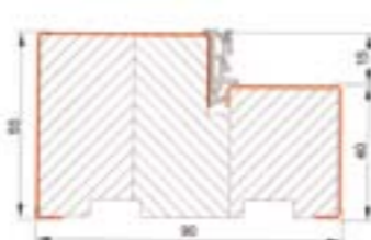
Ciepła ościeznica stalowo-drewniana z uszczelką do drzwi stalowych zewnętrznych 55, 55 LUX, 72, 72 LUX
